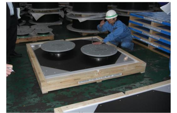
柱の直下に設置されたすべり材が、特別に表面処理した、鋼板(すべり相手材)の上をすべることで、地震の揺れが出来るだけ建物に伝わらないようにします。
