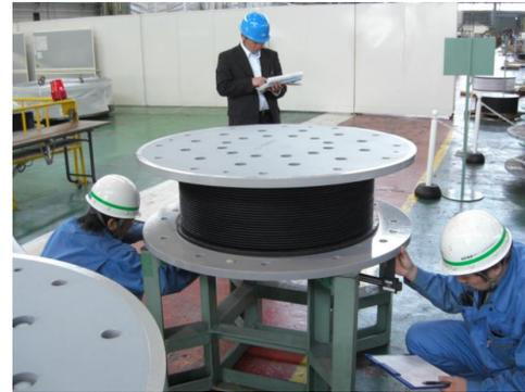
積層ゴム(アイソレーター)は、柔らかいゴムと硬い鋼板が交互に重なっています。「ゴムの柔らかさ」によって地震時に水平方向にゆっくり揺れ、「鋼板の硬さ」によって、重い建物を安定に支えます。しかし、積層ゴムのゆっくりした揺れは、元に戻るのに時間がかかるので、ダンパーを併用します。
